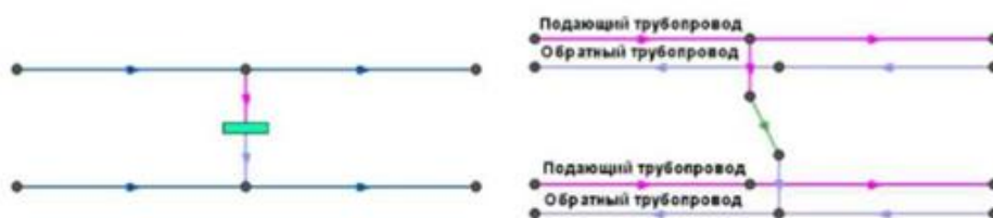
Рисунок 24 - Однолинейное изображение (слева) и внутреннее представление (справа) сети с перемычкой между подающим трубопроводом одного участка и обратным трубопроводом другого участка.
