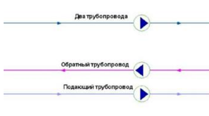
Рисунок 19 - Однолинейное изображение (вверху) и внутреннее представление (внизу) сети с насосными станциями.
